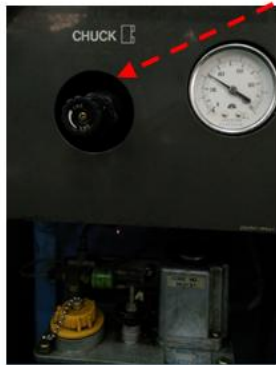
ภาพที่ 14 การปรับค่าแรงดัน สำหรับการจับยึดชิ้นงาน (Chuck)
