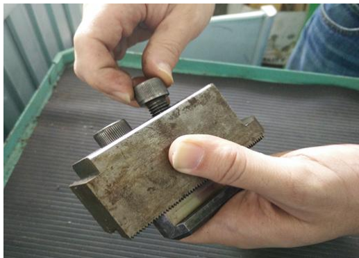
ภาพที่ 17 การประกอบปากจับอ่อนกับ T-nut ด้วย Screw แต่ละปากจับ
