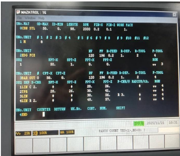
รูปแบบ Mazatrol Program ที่เขียนตามแบบ
