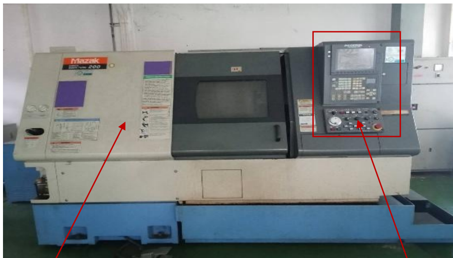
ภาพที่ 5 เครื่องกลึง CNC MAZAK Super Quick Turn 200
