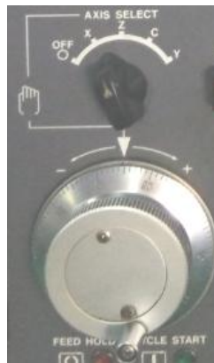
ภาพที่ 12 ชุดควบคุมการเคลื่อนที่ของเครื่องตามแกน X และแกน Z โดยให้ใช้แบบ manual
