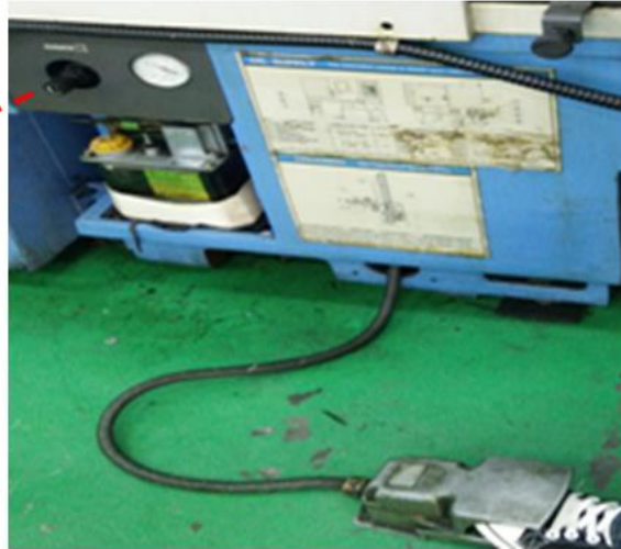
ภาพที่ 14 การปรับค่าแรงดัน สำหรับการจับยึดชิ้นงาน (Chuck)
