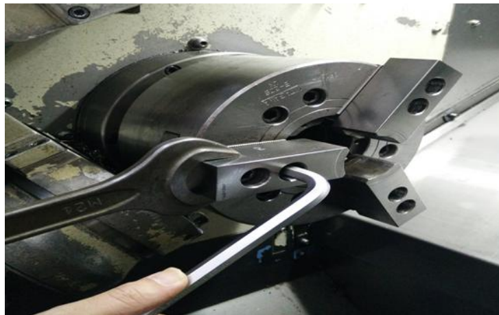
ภาพที่ 18 การถอดเปลี่ยนขนาดของ Soft jaw
