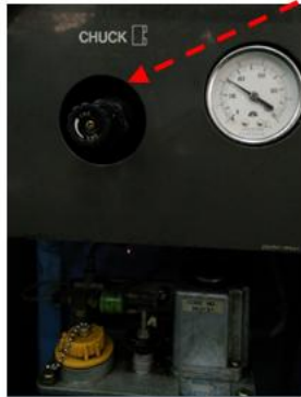
ภาพที่ 14 การปรับค่าแรงดัน สำหรับการจับยึดชิ้นงาน (Chuck)
