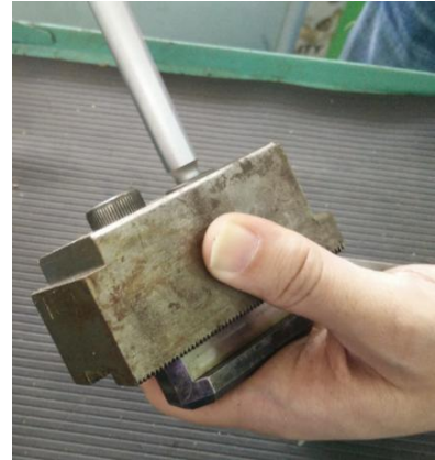
ภาพที่ 17 การประกอบปากจับอ่อนกับ T-nut ด้วย Screw แต่ละปากจับ
