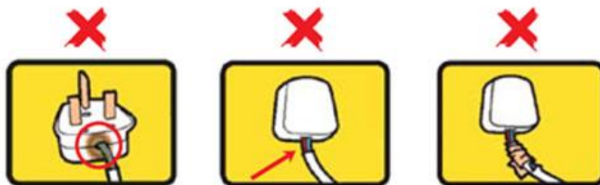
รูปที่ 2 อุปกรณ์ไฟฟ้าที่ชำรุดหรือเสื่อมสภาพ
