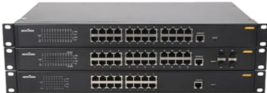
ภาพที่ 1.9 แสดงลักษณะ Switching Hub
