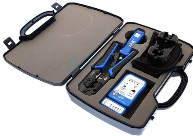
ภาพที่ 3.24 แสดงเครื่องมือที่ใช้ในการเข้าหัว RJ-45
