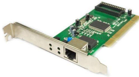
ภาพที่ 1.5 แสดงลักษณะการ์ดเครือข่าย (LAN Card)
