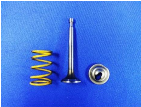
ภาพที่ 2.9 ชุดอุปกรณ์ลิ้นของเครื่องยนต์เล็กเบนซิน
