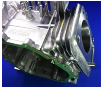
ภาพที่ 2.5 เส้สูบบอกแบบให้มีลักษณะเป็นครีบของเครื่องยนต์เล็กเบนซิน
